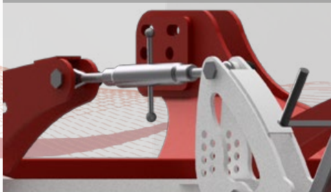
Manualna regulacja głębokości roboczej
