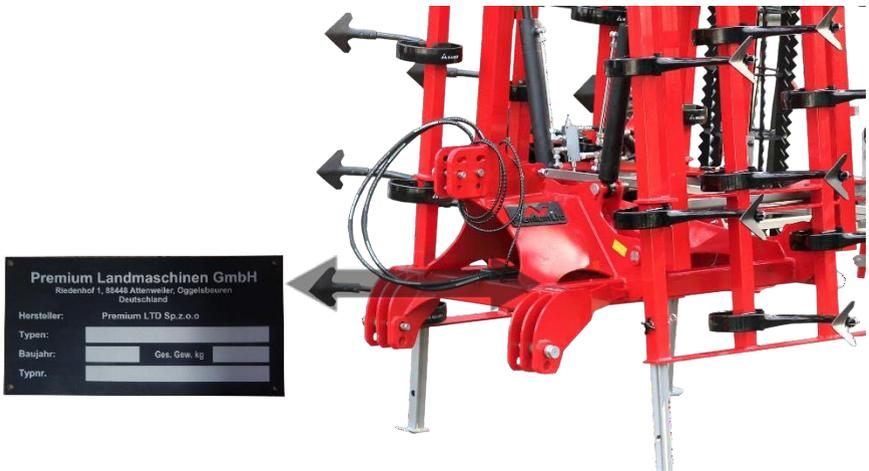
Abbildung 1. Anbringung des Typenschildes an der Maschine.
