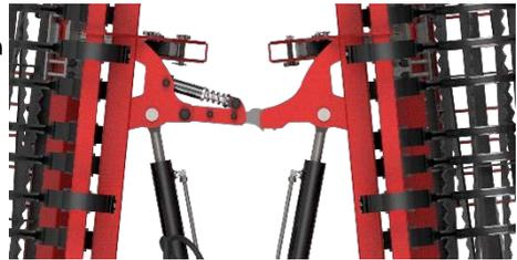
Abbildung 6. Automatische hydraulische Verriegelung
