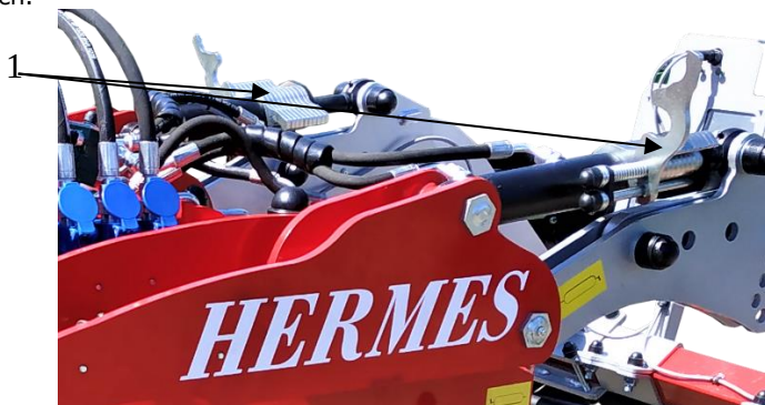
Rys.3. Regulacja głębokości pracy maszyny za pomocą zapadek zmniejszających skok siłowników. Pkt. 1 – zapadki blokujące.
