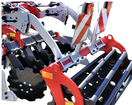
Rys.3.2. Regulacja opadania wału oraz regulacja odległości wału od belki talerzowej.
