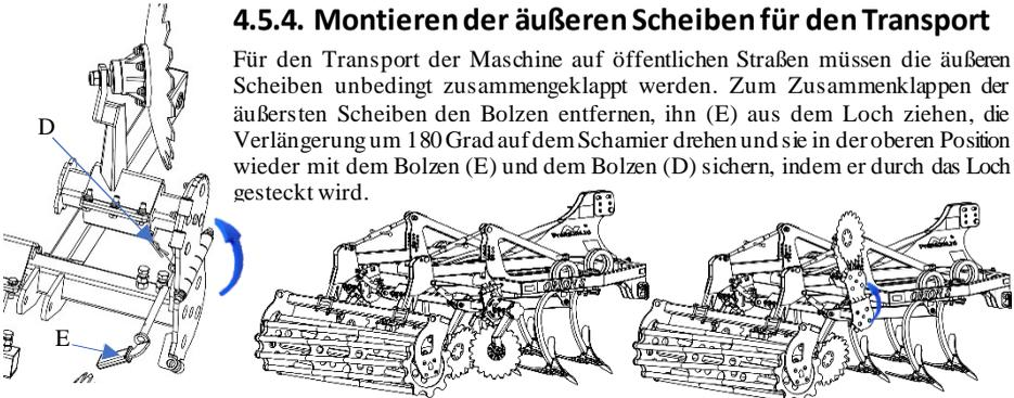
Abb. 11. Die äußersten Scheiben für den Transport abmontieren.
